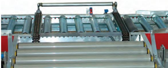
Bild: In eine Rollenbahn eingebauter Kettenabschieber.
