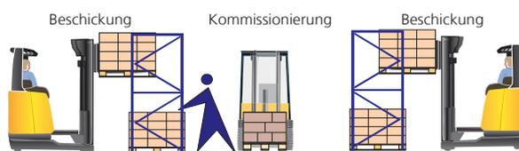
Durch Trennung der Beschickungs- und Entnahmeseite wird die Kommissionierung durch den Nachschub nicht beeinträchtigt.
