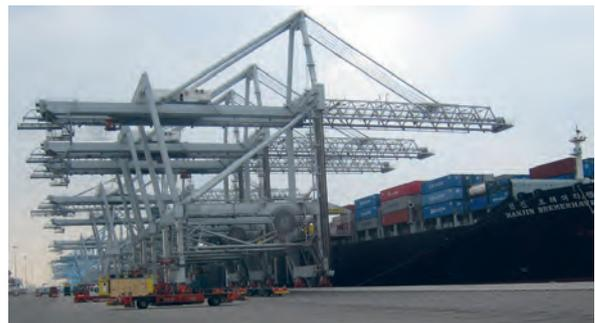
Auslegerkräne werden unter anderem für die Beladung von Frachtschiffen eingesetzt.
