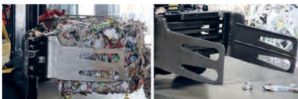
Ballenklammern werden unter anderem in der Entsorgungslogistik eingesetzt.
