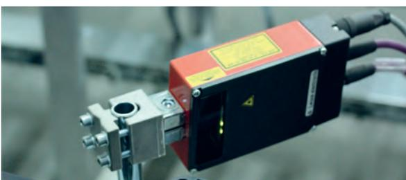
Lesegerät zur automatischen Identifikation von Behältern.
