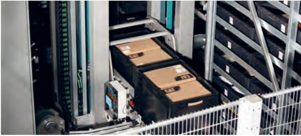
Ausschleusstation eines automatischen Kleinteillagers.
