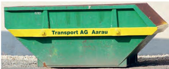
Absetzcontainer werden mit Hilfe einer hydraulischen Vorrichtung ebenerdig abgeladen und wieder aufgenommen.
