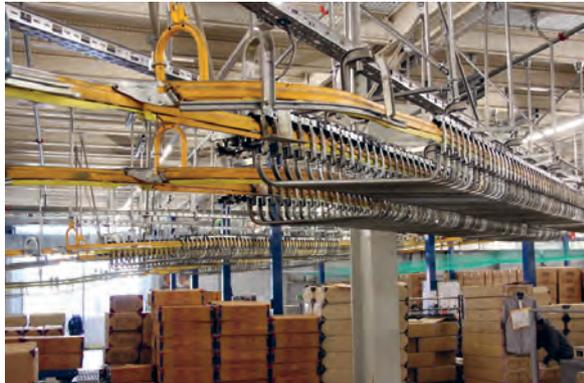
Power and Free-Deckenkreisförderer. Die Trolleys werden nach Bedarf über Mitnehmer eingesetzt. Bild: «Bahnhof» für nicht eingesetzte Trolleys.
