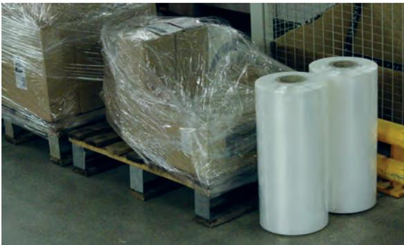
In der Lager- Umgangssprache wird die Adhäsionsfolie als Stretchfolie bezeichnet.
