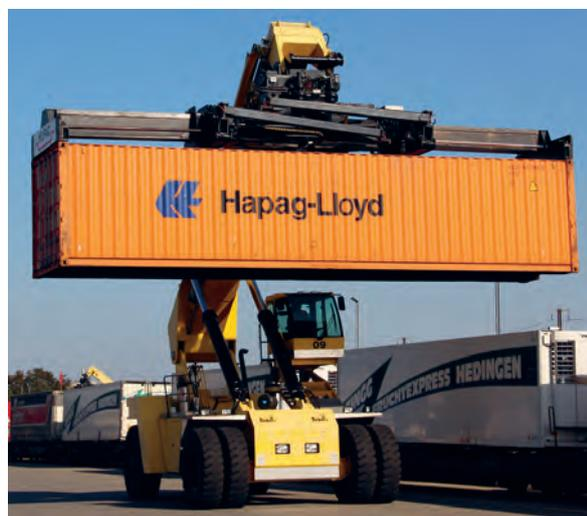
Containerstapler beim Transport eines 40-Fuss Containers.
