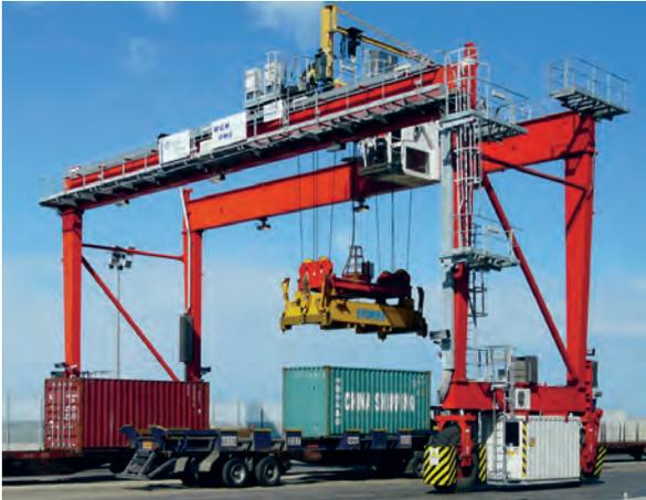
Container-Carrier beim Beladen eines Fahrzeugs. Die Portalkonstruktion dieses Container-Carriers ist so breit, dass Container parallel von einem Transportmittel auf ein anderes verladen werden können.
