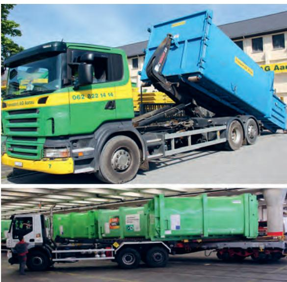
Oben: Der ACTS-Container wird über eine Rolle am Heck des Lastwagens abgerollt. Unten: Ein Presscontainer wird durch einen Lastwagen vom Tragwagen der Bahn übernommen.
