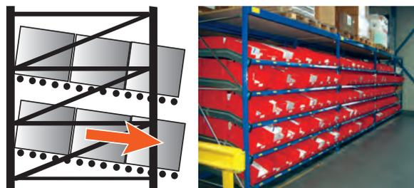
Durchlaufregal. Links: Schematische Darstellung der Funktionsweise. Rechts: Durchlaufregal von hinten.
