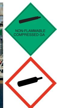
Links: Druckgasbehälter werden gut gesichert und am besten stehend transportiert. Rechts: Gefahrenkennzeichnung: Oben: ADR-RID. Unten: GHS. Die EU-Kennzeichnung kennt kein entsprechendes Symbol.
