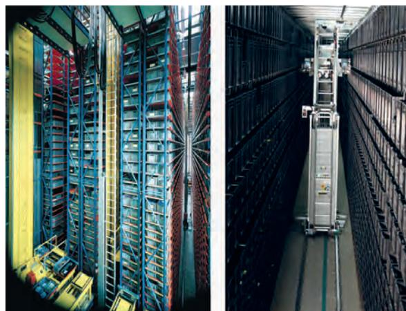
Blick in zwei verschiedene, automatische Kleinteillager (Behälterlager).
